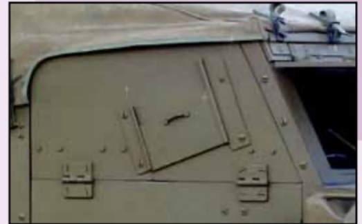
▲ De schuifluikjes op een M5 ▼ De luikjes op een M2. Let ook op het verschil in dikte van de raamstijlen.
