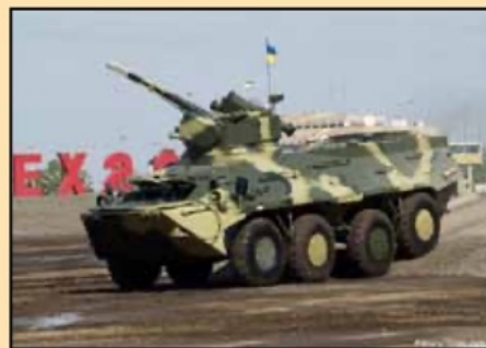
BTR-3E1 met de nieuwe "Shturm" toren
