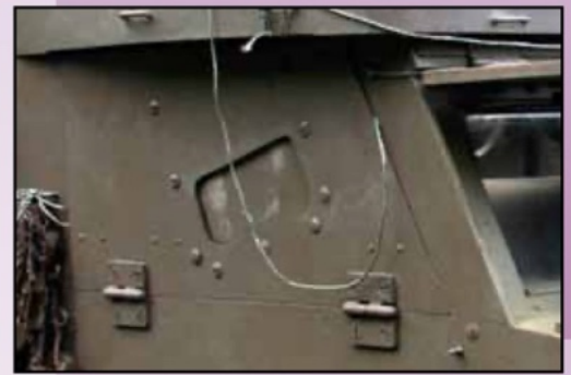
▲ De schuifluikjes op een M5 ▼ De luikjes op een M2. Let ook op het verschil in dikte van de raamstijlen.
